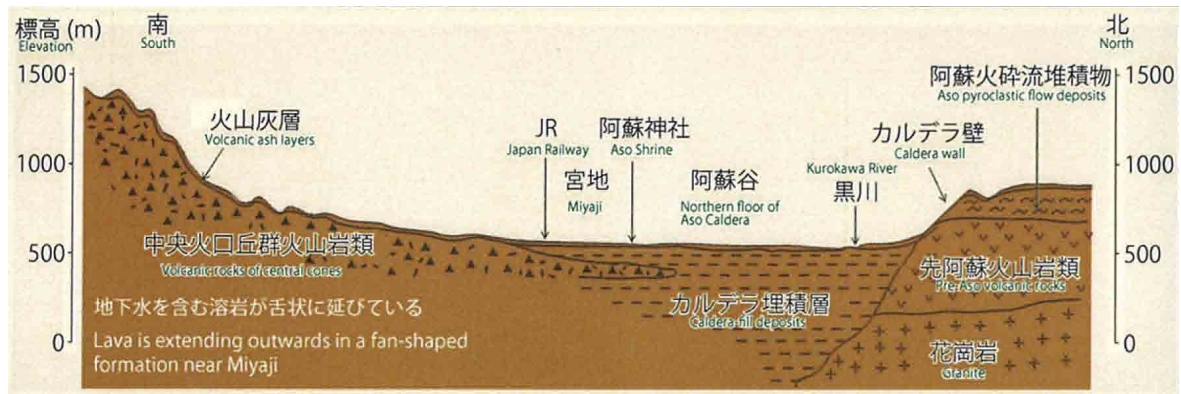
○阿蘇谷東部の推定地質断面図
