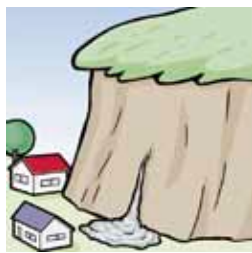
がけから水が湧き出ている
