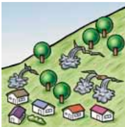
斜面から水が噴き出す
