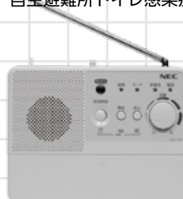
防災行政無線デジタル化整備工事で各世帯に設置された戸別受信機
