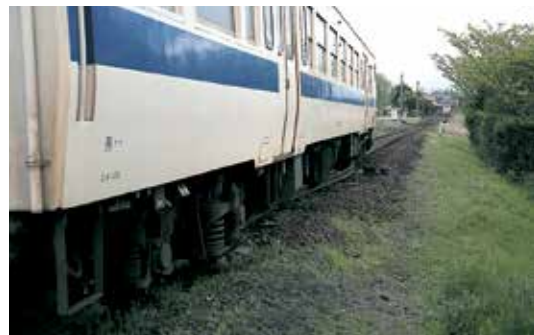
赤水駅付近を回送中だった列車はレールが曲がり脱線
