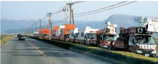
高圧発電機車による電気供給(国道212号沿い)
