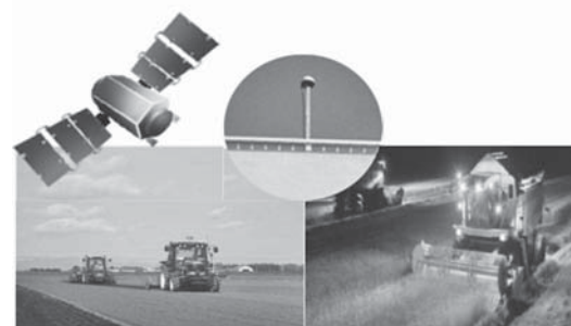
GNSS を利用した基地局と誤差数センチの作業実現
